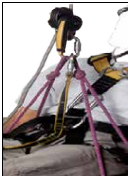
Figura 3. Asiento fabricado por el usuario. Anclaje incorrecto del mosquetón del cabo de anclaje al de unión del asiento con el dispositivo de descenso.
