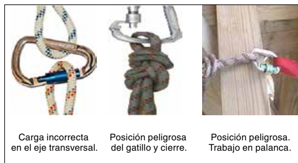
Figura 11. Ejemplos de utilización incorrecta de conectores.
