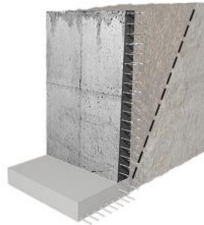
Propuesta de muro de HA. Fuente: banco de precios de Arquímedes (Cype Ingenieros)
